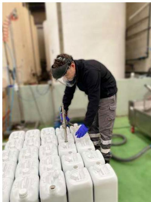
*Equipos de protección empleados por los operarios de Seipasa durante las tareas de envasado y formulación.*
